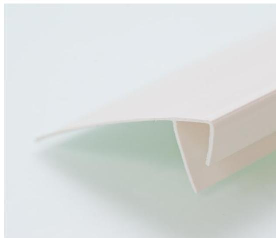
**F-профиль** позволяет декоративно закончить торцевые углы различных поверхностей: оконных и дверных проемов при отделке откосов сэндвич панелью или пластиковой панелью. За счет сужающейся формы боковых планок идеально крепится к торцу сэндвич-панели.
